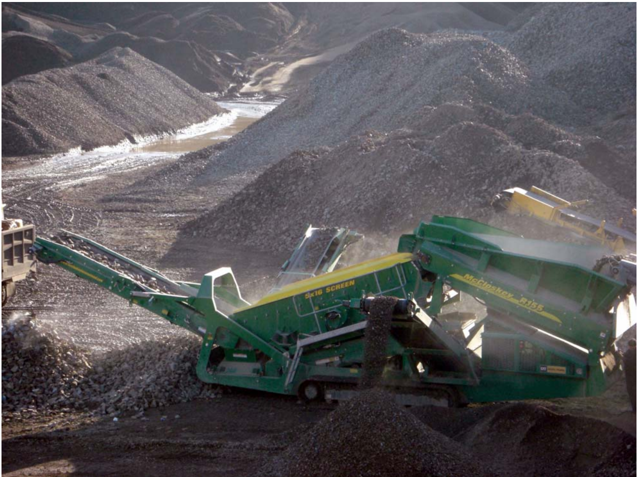
Совместная работа R-155 с дробильной установкой
